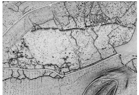
Un exemple du niveau de détail permis par la technologie LIDAR. Traitement géomatique Rémi Machado © Verdun « forêt d'exception » - mission Lidar DRAC/ONF 2013
