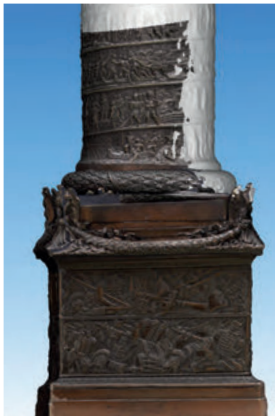
▶ Phase de montage : les photos (texture) sont « mappées » sur la structure 3D.
