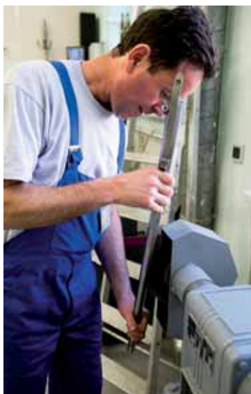
Atelier métal : phase de restauration d'un canon de fusil sur une polisseuse.
