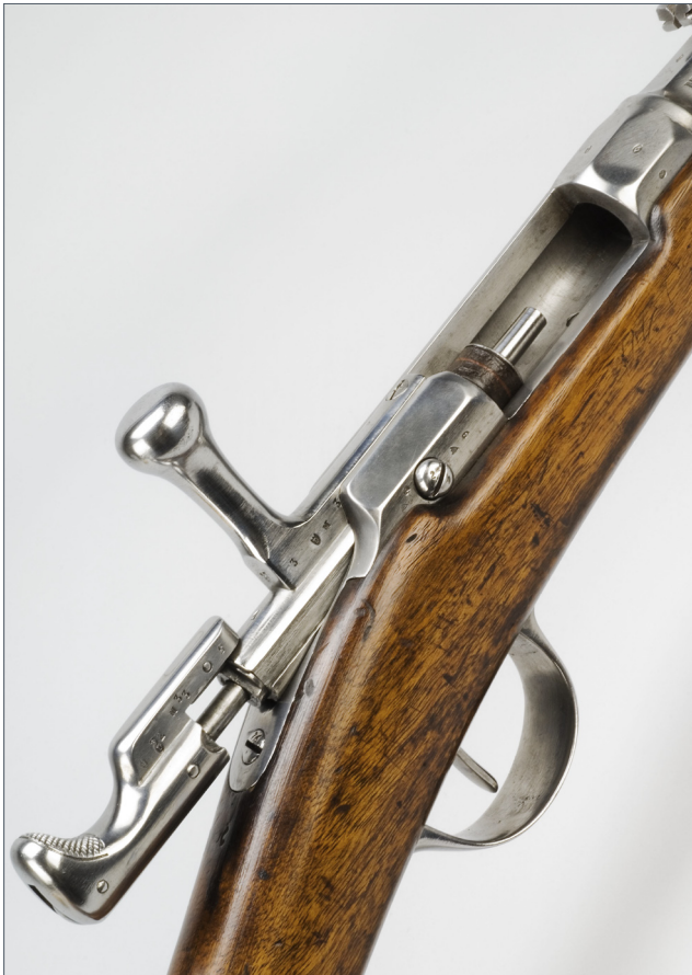
Culasse ouverte de Chassepot modèle 1866 ; Inv : M 2765 © Paris, musée de l'Armée/RMN-GP.
